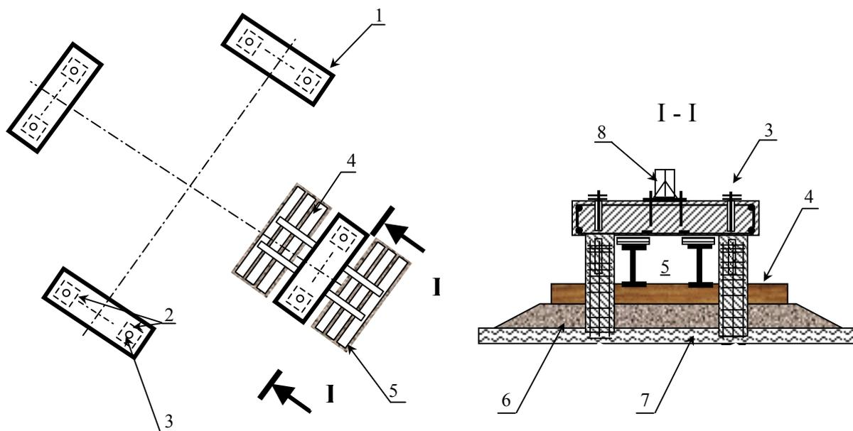
*Рис.3. Схема устройства пространственных временных опор при замене бетона омоноличивания оголовков свай с ростверком (план).*
