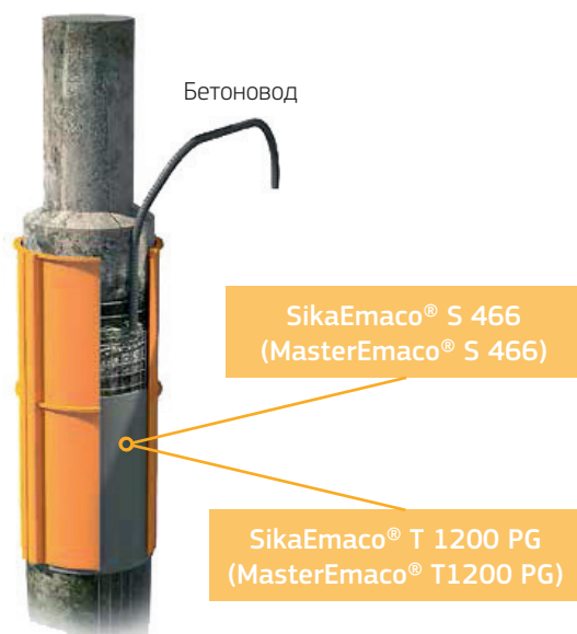
Ремонт с применением опалубки
