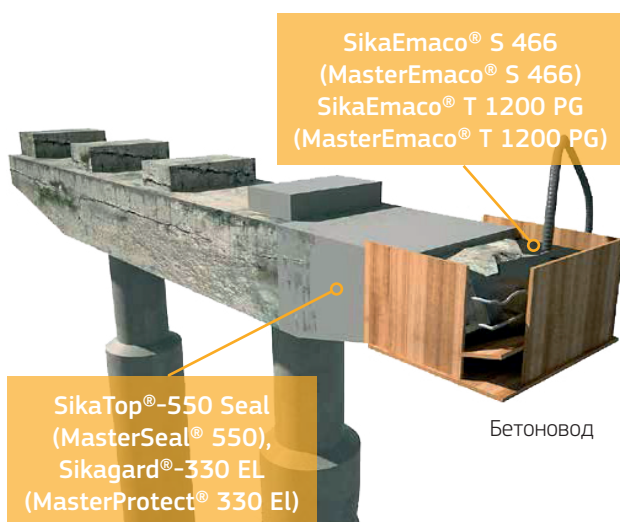
Восстановление разрушенной части конструкции с применением опалубки, с последующей защитой
